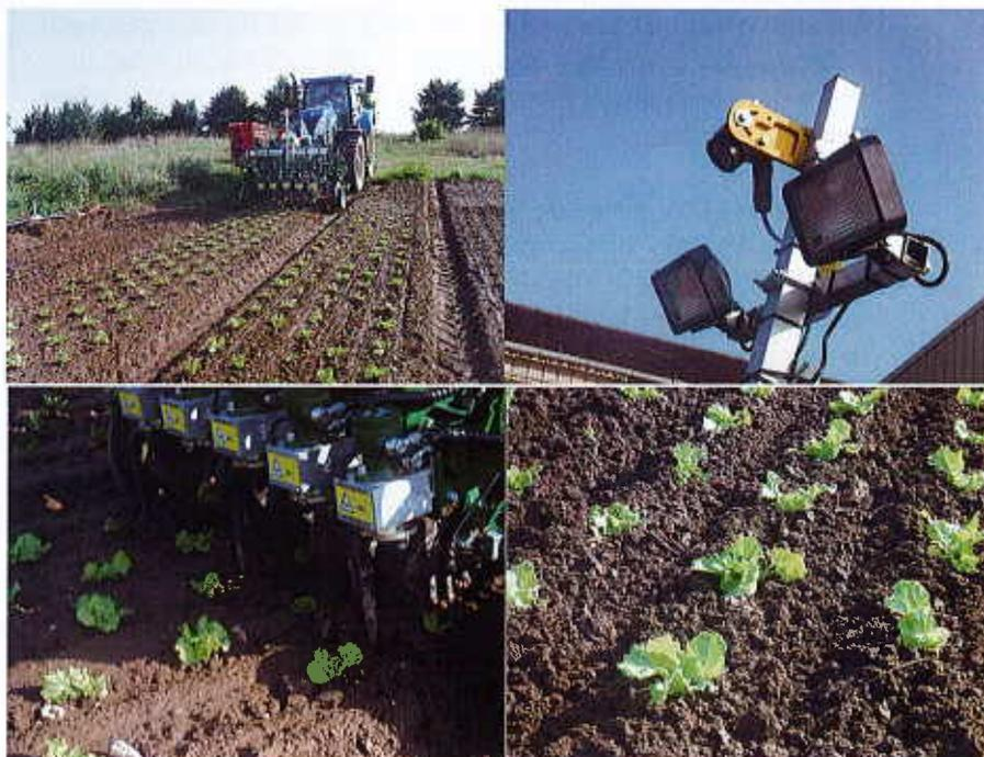
La bineuse, avec sa caméra, en action sur une planche de salade. Un binage au plus près des plantes (photo DRIAAF-SRAL)
